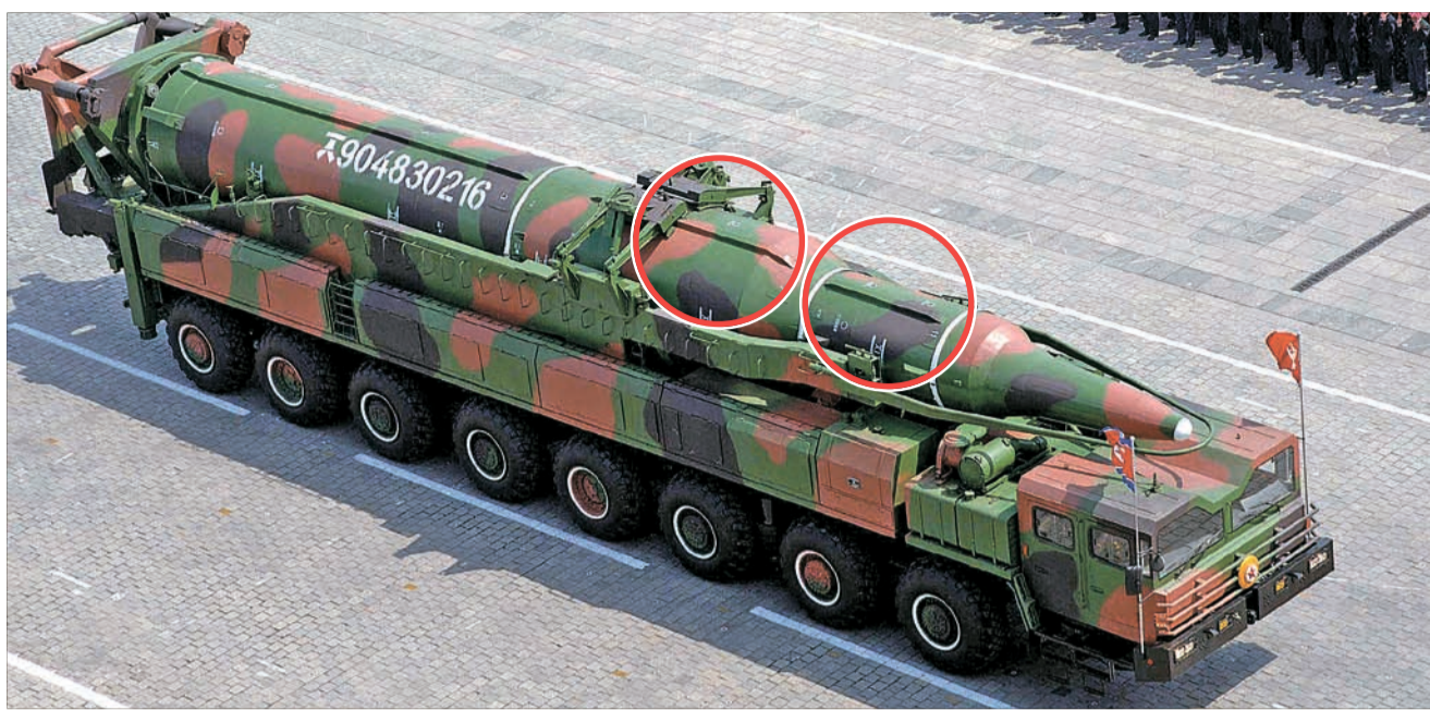
북한이 지난 15일 평양 퍼레이드에서 공개한 신형 이동미사일. 미국의 미사일 과학자는 촬영된 미사일 6기의 동체 표면에 있는 전선용 관(duct)의 설치 장소(빨간색 원 안)가 각기 다르다는 점을 근거로 이 미사일이 가짜라고 주장했다. 또 미사일을 고정하는 벨트의 위치에도 차이가 있으며, 재질 역시 통상의 미사일 같지 않고 종이를 여러 겹 바른 것처럼 보인다고 지적했다. [평양 로이터=연합뉴스]
